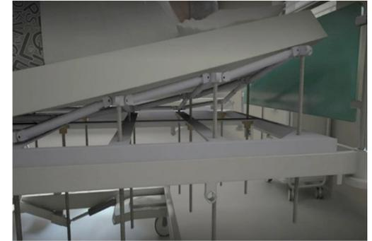
CAD-Zeichnung des Rahmens und Unterkonstruktion mit Linearaktuatoren zur späteren Realisierung der Verstellung der einzelnen Segmente des Pflegebetts
